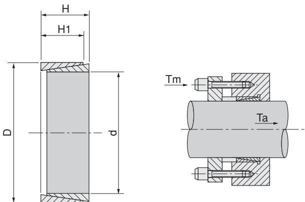
esempio di montaggio / example of assembly
