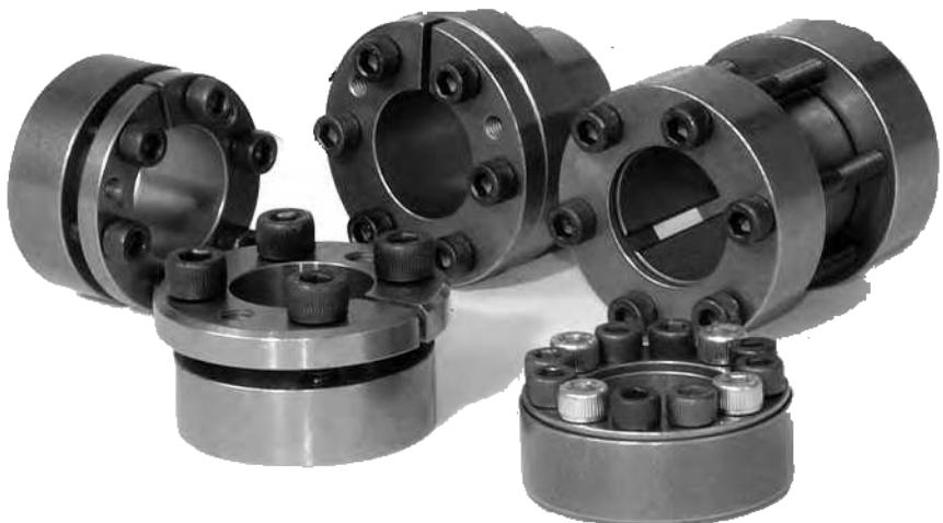
Il principio di funzionamento degli articoli presentati, si basa sulla deformazione radiale dei particolari, a profilo tronco conico, che li compongono: la coppia di serraggio applicata sulle viti di collegamento provoca un movimento assiale dei particolari a contatto tra loro ed, in funzione della conicità inversa e dei tagli longitudinali su di essi praticati, provocano un aumento di diametro (sull'anello esterno) ed una riduzione dello stesso (sull'anello interno).
