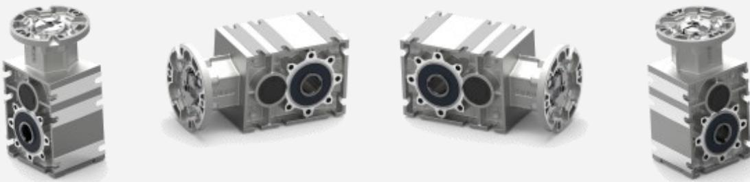
Les réducteurs orthogonaux à deux trains, Série RO-2, sont construits avec carcasse monolithique, engrenages coniques à l'entrée et un train cylindrique en sortie pour supporter des importantes charges extérieures.
