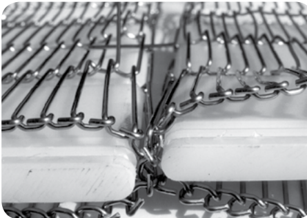
Banda de la competencia luego de ser sometida a prueba.
