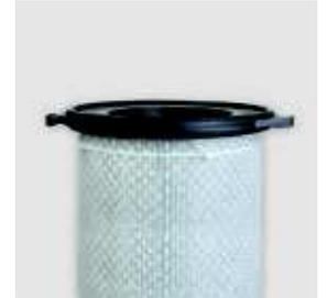
Los CPS se componen de un medio de filtración PES completamente sintético, que se caracteriza especialmente por una permeabilidad al aire muy elevada de aproximadamente 3.880 l/m<sup>2</sup>·s y un tamaño medio de poro de aproximadamente 50 µm. Las partículas finas pueden penetrar el medio de filtración, las partículas gruesas se retienen.
