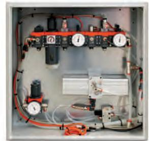
Metal Work y Metal Work Service pueden proporcionar kits personalizados, ya sea como un conjunto de componentes individuales o como paneles electro-neumáticos completos, montados y probados.
