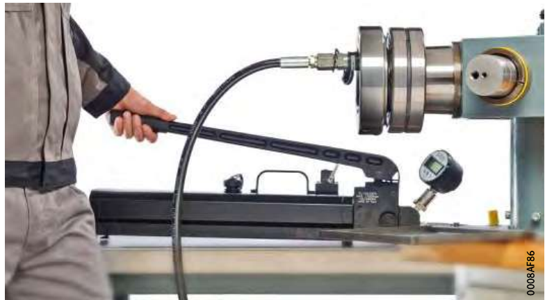
Figura 14 Desmontaje hidráulico con asientos cónicos
