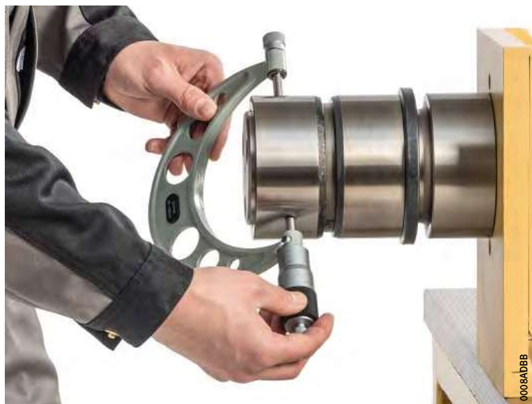
Figura 3 Medir la expansión mediante un micrómetro exterior
