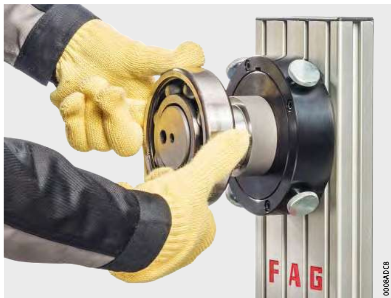
Figura 14 Montaje de las piezas calientes del rodamiento
