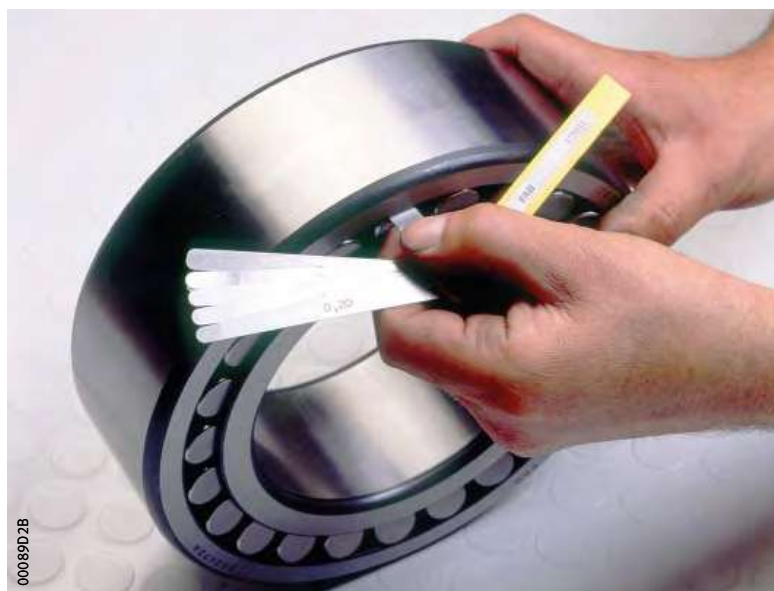
Figura 7 Medición del juego radial mediante galgas de espesor
