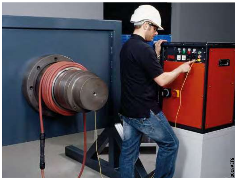
Figura 10 Desmontaje de anillos interiores mediante inductores flexibles
