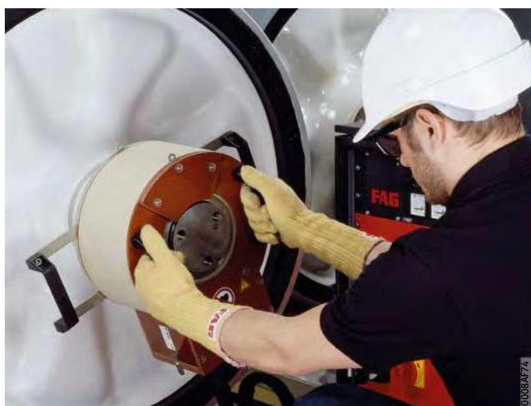
Figura 11 Desmontaje de los anillos interiores de rodamientos de ruedas (vehículos sobre raíles) con inductor fijo
