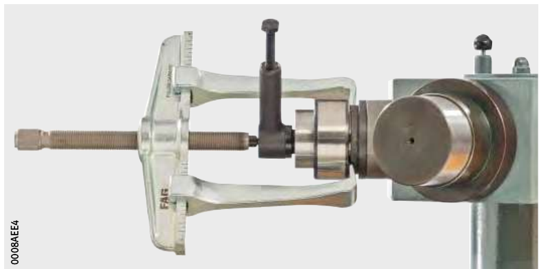
Figura 7 Extractor de dos brazos con herramienta hidráulica de presión
