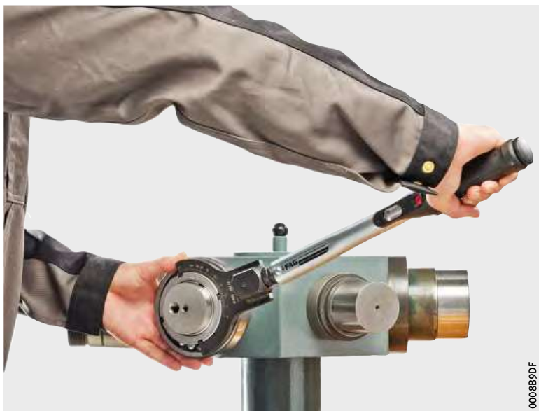
Figura 11 Montaje mediante llaves de doble gancho
