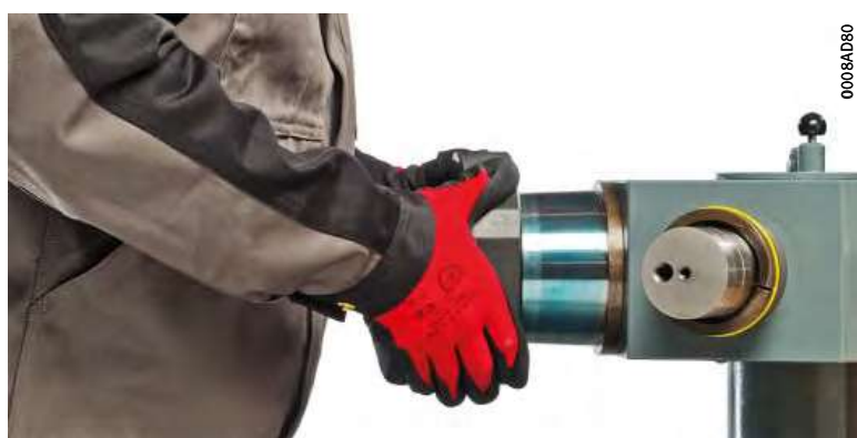
Figura 5 Control con azul de prusia y un aro calibre cónico
