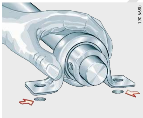
Figura 19 Deslizar el soporte sobre el eje
